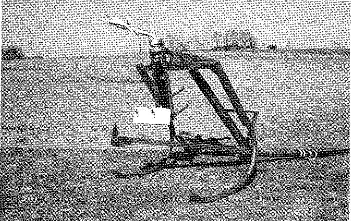
La hauteur de buse du canon monté est d'env. 2,2 m. Le canon n'est pas incliné à l'arrivée du traîneau, mais grâce au dispositif pendulaire il est toujours dans une position assurant une portée et une répartition de l'eau optimales. Le dispositif pendulaire compense également des pentes du terrain le long du sens d'enroulement.
