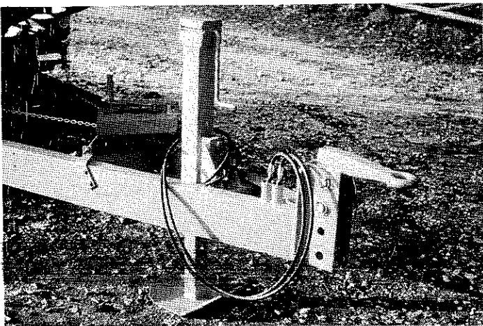
**Important:** Il peut arriver que l'appareil s'incline, si l'on actionne les vérins hydrauliques et que le Rainstar n'est pas équipé d'une commande. Pour la voie la plus étroite la différence de niveau horizontale avant de descendre les béquilles ne doit pas dépasser 15 cm (mesuré par rapport aux roues). La barre d'attelage doit être complètement abaissée.
