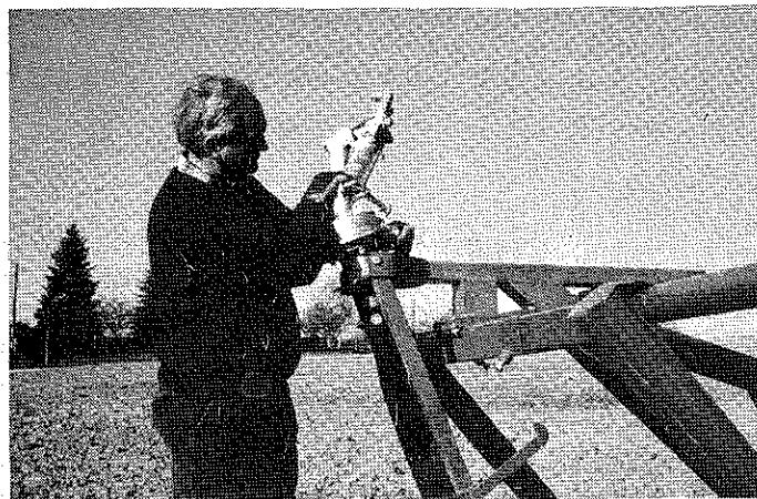
Régler le secteur au canon (env. 220° pour toute la largeur de bande). Pour d'autres indications veuillez voir les propres instructions de service du canon. Le WINDGUN peut être ajusté aux conditions de vent momentanées en réglant l'angle d'élévation du jet.
