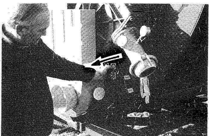
Débloquer le levier d'accouplement en enlevant le boulon de fixation et l'amener à gauche en position "enroulement du tube PE", lorsque la pression de service est atteinte et que de l'eau pure sort du canon en plein jet.
